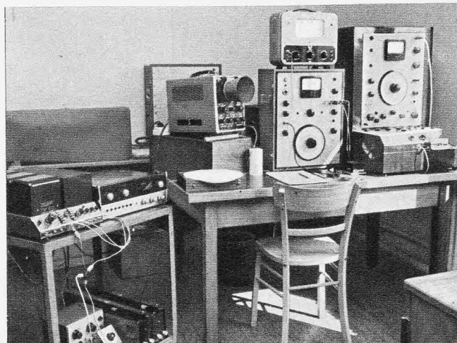
Bild 2. Lautsprecherboxen-Meßplatz mit Signalgenerator, Pegelschreiber (rechts) und daneben angeordnetem, umlaufendem Terzfilter. Links sind Vor- und Leistungsverstärker (75 W) zu sehen, darunter ein Regelverstärker für die Impedanzmessung und Ersatzwiderstände. Die Ausgangsspannung des Verstärkers wird mit Röhrevoltmeter (auf dem Terzfilter stehend) und Oszillograf überwacht
